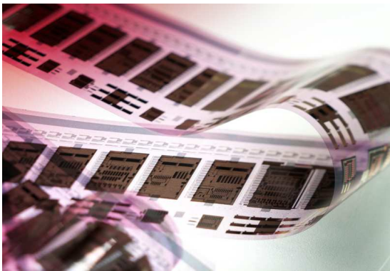
PolyIC: Mile long printed logic circuits for RFID tags PolyIC: Kilometerlange gedruckte Schaltungen für RFID-Tags
