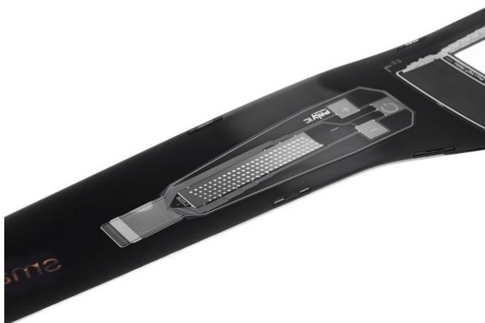
Im FFB-Verfahren integrierter Sensor für die Ambientelicht-Steuerung (Foto: Kurz)
