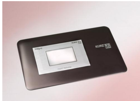
Multitouch-Demonstrator mit PolyTC® Folien und Dekorfolie von Kurz
