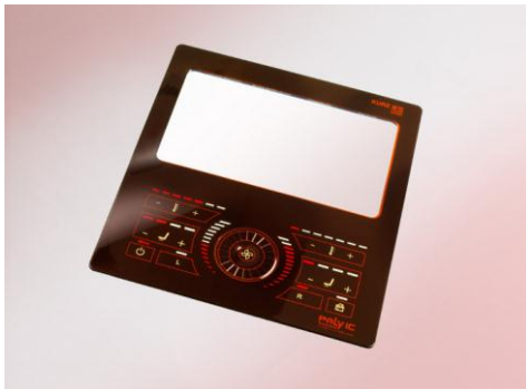
Touchkey-Demonstrator mit PolyTC® Folien und Dekorfolie von Kurz
